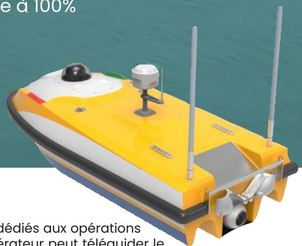
Les SL20 et SL40 sont des drones de surface (USV) autonomes dédiés aux opérations de bathymétrie en eaux intérieures et en littoral. Un unique opérateur peut téléguider le drone à distance jusqu'à 1km, ou planifier les profils de bathymétrie pour une mission en mode autonome.
